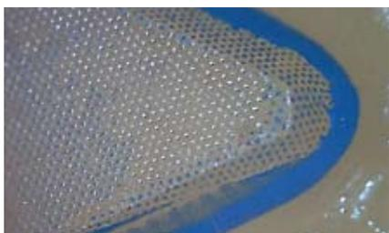
Пример дефекта флексографской формы из за чрезмерного давления анилоксового вала: на поверхности виден отпечаток гексагональной ячейки анилокса, след остался даже на «цоколе» печатного элемента.
